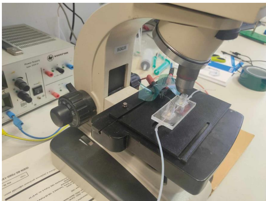
Obr. 2: experimentální set-up pro stanovení elektroforetické mobility trasovacích částic.
